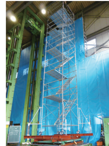
ローリングタワー使用時の安定性検証 傾斜実大実験 (仮設工業会)
